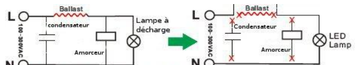
Ballast ou transfo doivent être shunté avant installation
